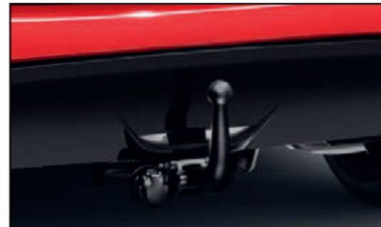
Anhängerzugvorrichtung mit abnehmbarer Kupplungskugel, horizontale Verriegelung
